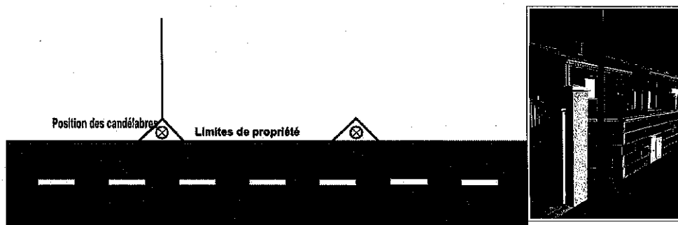
Illustration 1: Profil en V : position de l'éclairage
